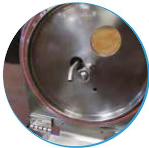
**Tubulure de rinçage** du gâteau avec un ou plusieurs gicleurs orientables.
